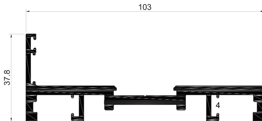
DI.37 Perfil Central Reforçado
